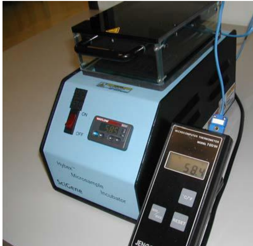
数字温度计连接到微型恒温箱，温度差为0.1 °C
