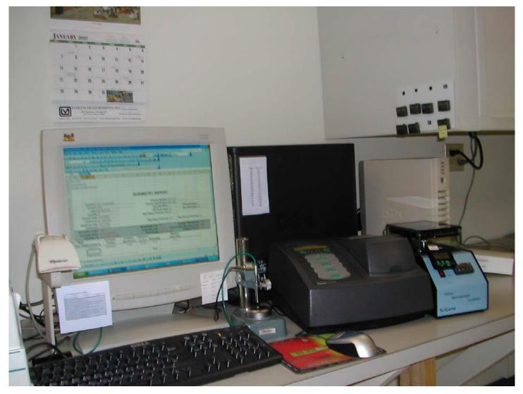
Genesys20分光光度计及剂量计支架 微型恒温箱热处理系统 计算机、条码阅读器和WINdose for Excel软件
