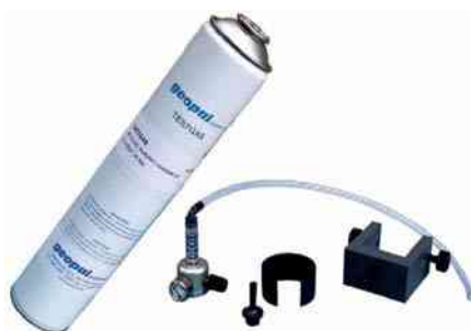
图 3 EA10208D 固定式气体探测器试验工具
